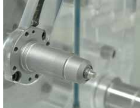
Abb. 4: Nadelführung LA im eingebauten Zustand Fig. 4: LA variant of the needle guide when installed
