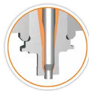
Abb. 2: Nadelführung schwimmend in der Heißkanaldüse montiert Fig. 2: Needle guide mounted on floating bearings in the hotrunner nozzle
