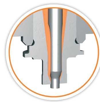
Abb. 2: Nadelführung aus PM-Stahl, schwimmend in der HK-Düse montiert/ Fig 2: needle guide made of PM steel, mounted on floating bearings in the hot-runner nozzle
