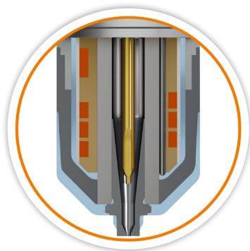
Abb. 1: Aufbau einer Heißkanal-Nadelverschlussdüse mit Nadelführung/ Fig. 1: Construction of a hot-runner valve-gate nozzle with needle guide
