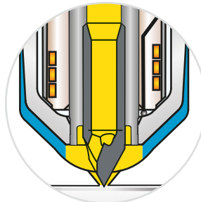
Anschnittgeometrie Offene Düse mit Spitze
