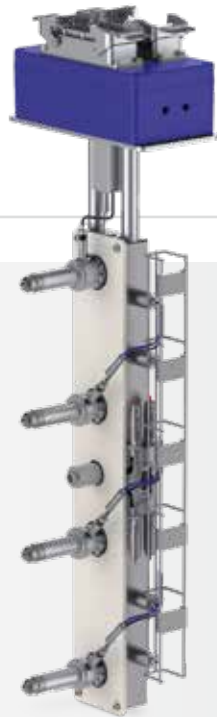
Komplett montiertes System Offenes Heißkanalsystem 4-fach
