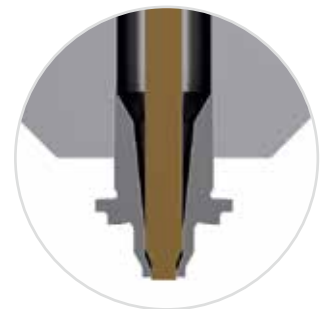
4 Nadelführung in der Düse
