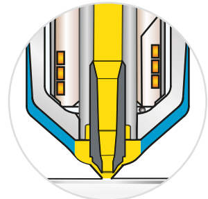
Anschnittgeometrie Offene Düse mit geradem Durchlass
