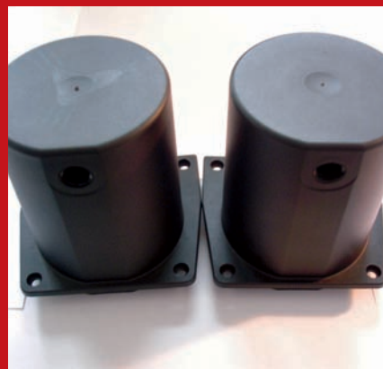
Links ohne, rechts mit Kombi-Steckspitze gespritztes Bauteil: Fließmarkierungen sind nicht zu erkennen.
