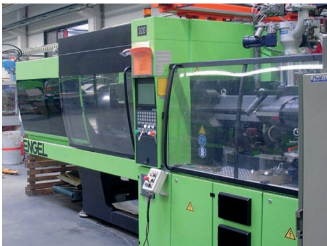
Die Leuchtenabdeckungen produziert der Verarbeiter auf einer Engel-Spritzgießmaschine vom Typ 1050/200 mit 2 000 kN Schließkraft.
